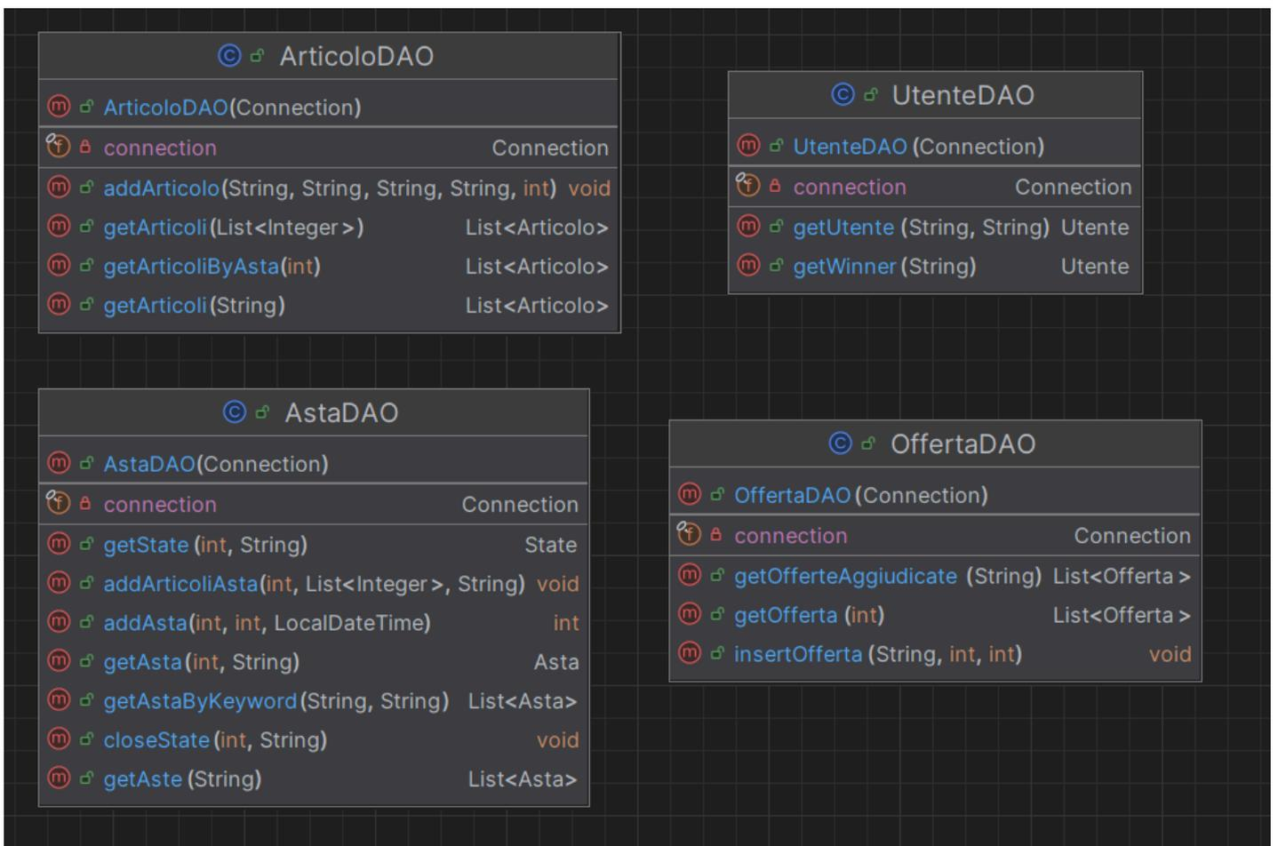
L'immagine soprastante invece rappresenta l'UML dei DAO. Come possiamo notare in ognuno di essi è presente l'attributo connection che serve per creare una connessione con il db nel momento della creazione nelle Servlet. Per preservare l'atomicità nel DAO vengono chiamate singole operazioni al db rendendo così evidentemente che non c'è possibilità di fallire operazioni oltre a quella effettuata gestita con un adeguato try catch.
